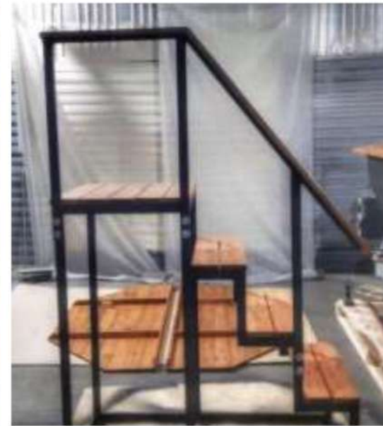
Лестница из металлокаркаса с площадкой
